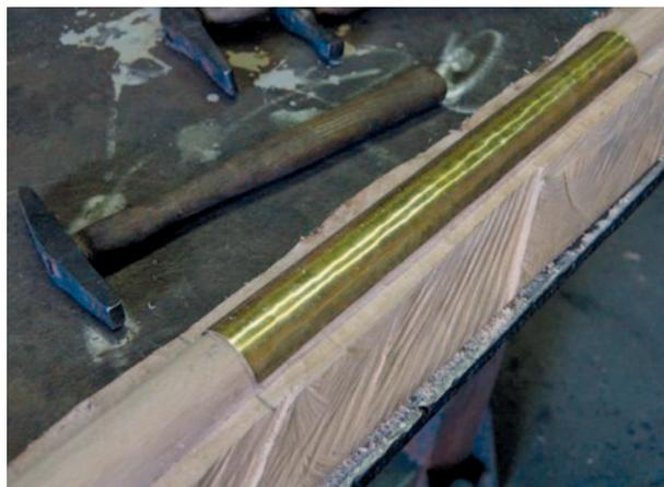
Fig. 17. Supporti in legno realizzati per la replica in ottone e da utilizzare anche per la ricostruzione in bronzo (foto A. Ervas).
